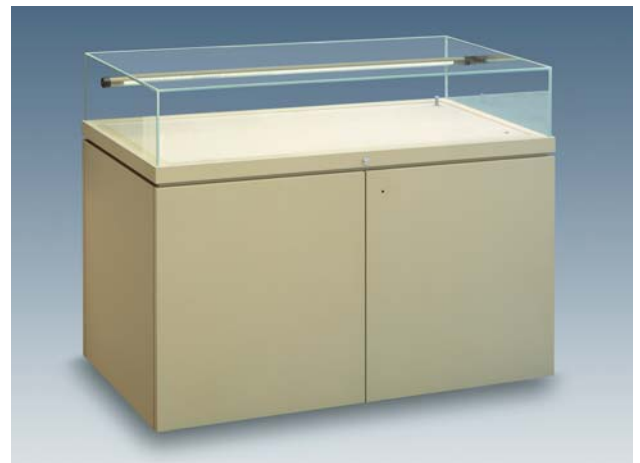
Beleuchtung bei Tischvitrinen GLASBAU HAHN hat speziell für Tischvitrinen eine Leuchte mit nur 25mm Durchmesser entwickelt. Sie besteht aus einem Stab, bestückt mit weiß leuchtenden Leuchtdioden, der zwischen die Seitenglasscheiben der Vitrine eingespannt wird. Die Stromzufuhr erfolgt unsichtbar durch diese Glasscheiben. Die Lichtfarbe kann durch Filter-Folien beeinflusst werden. Foto von MUTEC-Tischvitrine
