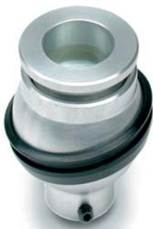
Saturn , Kugelfassung mit Optikvorsatz, zum Einbau in 1,5 oder 2mm Stahlblech, schwarz oder Aluminium natur eloxiert Saturn , spherical socket with movable and focusable lens, for mounting in 2mm or 1,5mm sheet metal, finish: black or natural anodized aluminium
